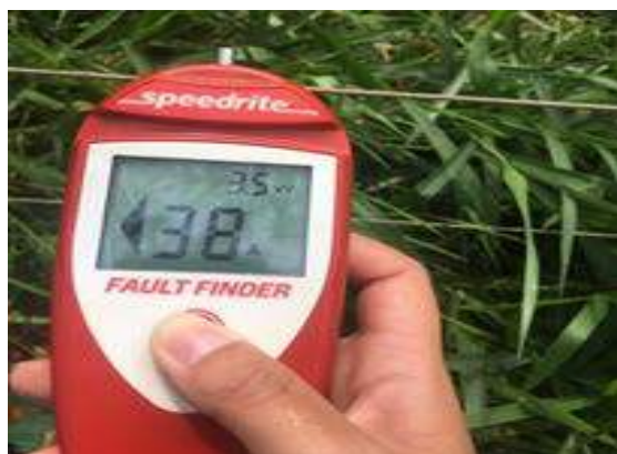
Figura 50: Voltímetro utilizado na fazenda para manutenção e acompanhamento da cerca elétrica.
