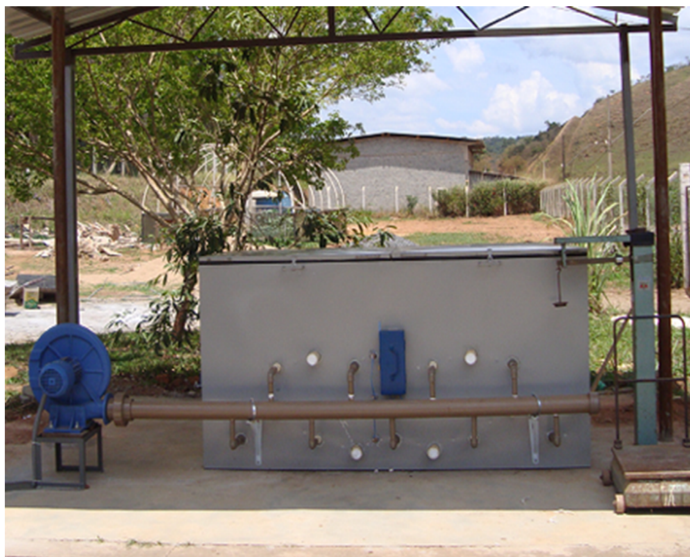
Figura 5. Modelo de biodigestor batelada. Fonte: Embrapa, 2011.
