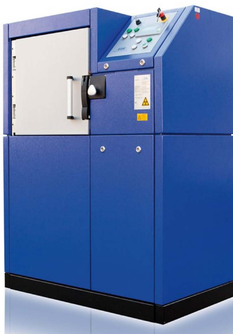
Figura 22. Esterilização por raios gama. O processo de esterilização acontece devido às colisões entre os fótons de raios gama e os elétrons dos átomos do produto a ser esterilizado ... [com] a ionização ... A desnaturação de polímeros, como DNA, RNA e proteínas elimina a capacidade de reprodução.
