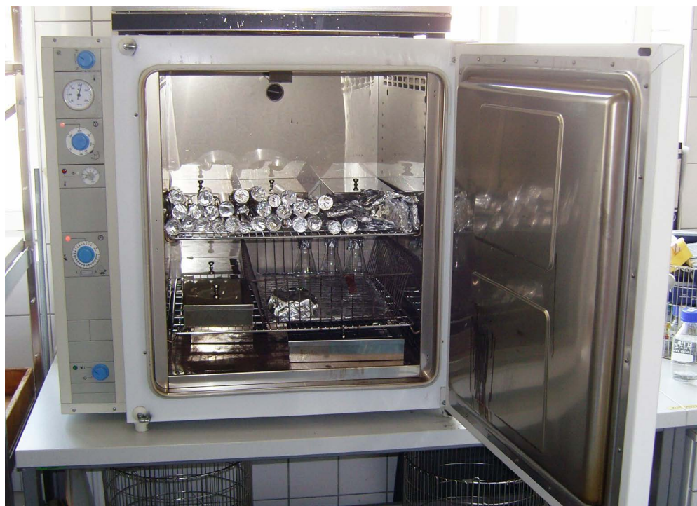
Figura 21. Estufa de Pasteur. Para controlar doenças contagiosas, Louis Pasteur (1822-1895) desenvolveu a estufa de Pasteur. Essa tinha a finalidade de eliminar esporos de artigos que suportam temperaturas acima da fervura da água.
